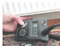
Nr. 54 - Eksempel på fugtmåling i facadevæg ud mod have.
